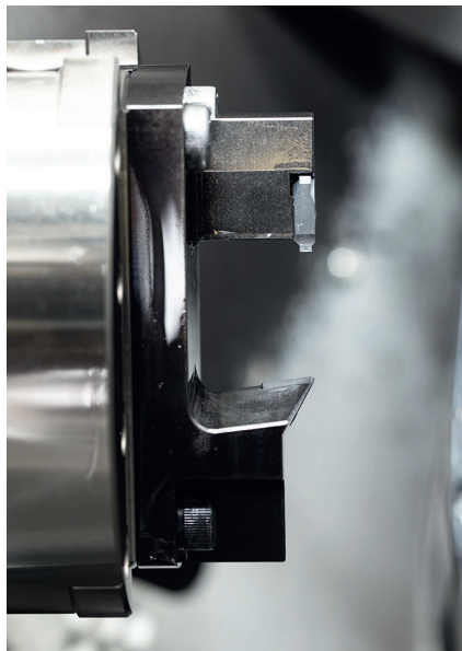
6 Dieses Horn-Kombiwerkzeug kommt auf einem Planschieber für die zwei Funktionen Feindreihen (außen) und Präzisionseinstechen zum Einsatz © Horn/Sauerermann
